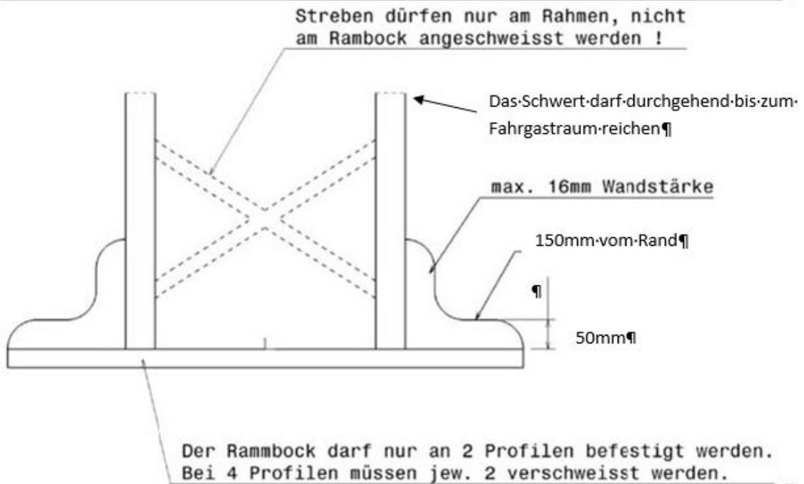
D.3.2. TÜREN: Türen (z.B. VW-Käfer) müssen voll verschweißt sein. An der Fahrerseite ist ein Schutzblech mit mind. 5 mm Stärke und innen Rohre mit mind. 38 mm DM und ein Querrohr mit 38mm DM und einer Wandstärke von min. 2,6 mm welches von Höhe der linken Schulter bis zum linken unteren Eck des vorderen
